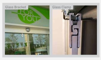
Glass Bracket - For 10mm glass door 90kg max / 1.2m width max & 12mm glass door 120kg max / 1.5m width max
